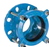
Серия 603 Фланцевый адаптер Supra® универсальный для труб из НПВХ, АЦ, стали, литейного и ковкого чугуна. Универсальная рассверловка Ковкий чугун DN 40-400 PN 10/16
