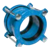
Серия 601 Прямой соединитель Supra® универсальный для труб из НПВХ, АЦ, стали, литейного и ковкого чугуна. Ковкий чугун DN 40-400 PN 16
