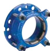
Серия 623/10 Фланцевый адаптер Supra Plus™ Упругий (устойчивый) для ПЭ и НПВХ труб. Универсальная рассверловка Ковкий чугун DN 40-300 PN 10/16
